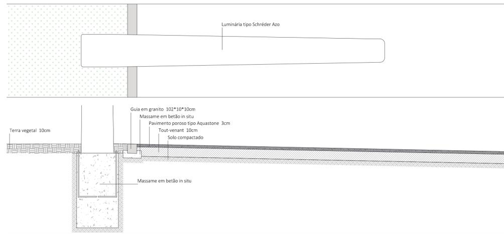
P2 | Fixação de luminária e transição pavimento / zona verde Planta e corte | escala 1/20
