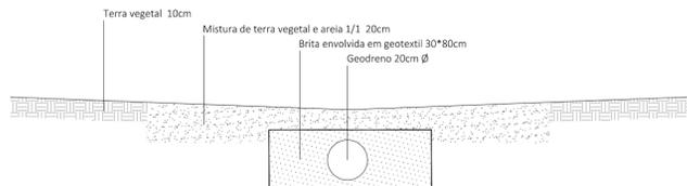
P4 | Bacia de retenção Planta e corte | escala 1/20
